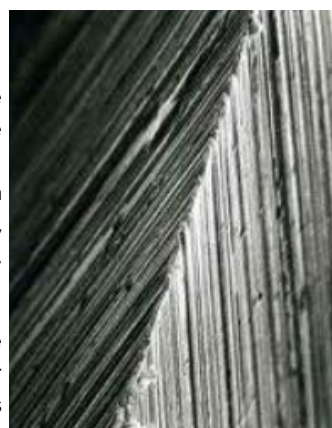
Tranchant de katana au microscope optique : le multi-lame !
